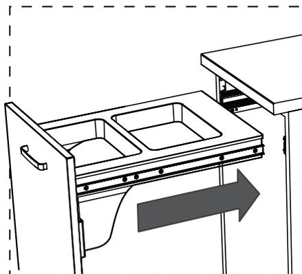
Вставьте раму (B) в крепежную часть направляющих (C).
