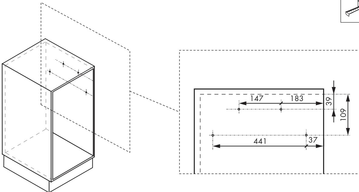
Сделайте разметку корпуса согласно заданным размерам для установки крышки с крепежной частью направляющих (С).
