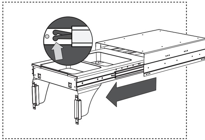
Нажмите на рычаг с двух сторон и снимите крышку (С).
