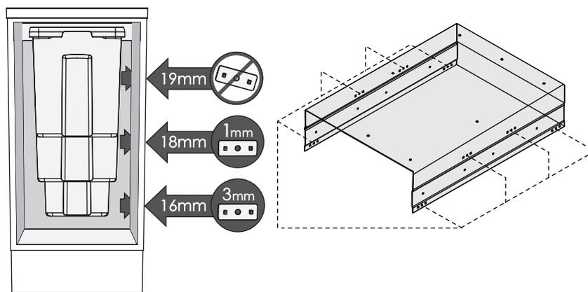
При установке системы в корпус с толщиной ДСП 16 или 18 мм используйте проставки (Е или F).
