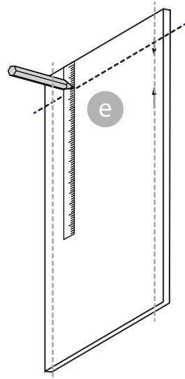
Сделайте разметку фасада согласно заданным размерам для установки рамы с фасадными креплениями (B).
