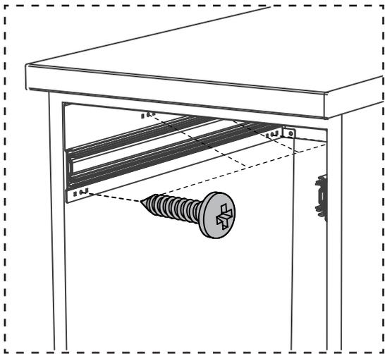
Зафиксируйте крышку системы (С) на боковинах корпуса шкафа винтами (D).
